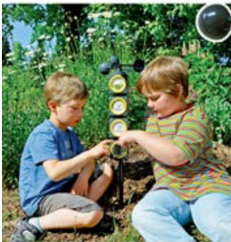
תחנה למדידת מזג אויר ₪ 219 עמדה מלאה למדידת נתוני מזג האויר. על גבי עמוד מרכזי מותקנים: מד מהירות וכיוון הרוח, מד טמפרטורה, ומד גשם. בגובה 65 ס"מ.
